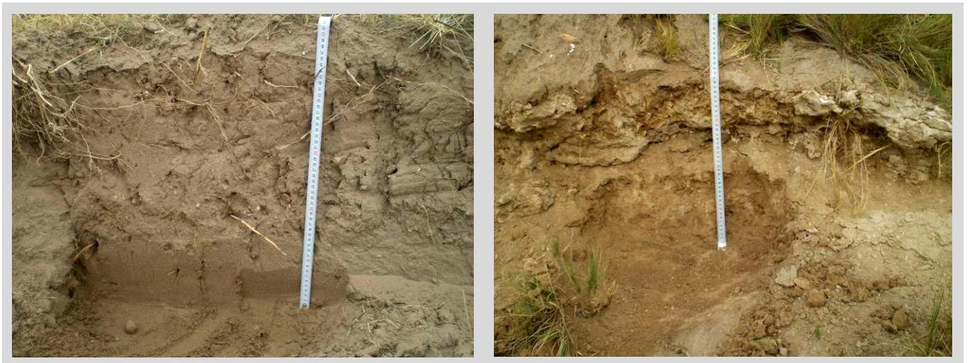
**Figura 189.** Perfiles sedimentarios en S9 y S10. En la foto de la derecha se indica con recuadro el nivel de arcillas consolidadas.
