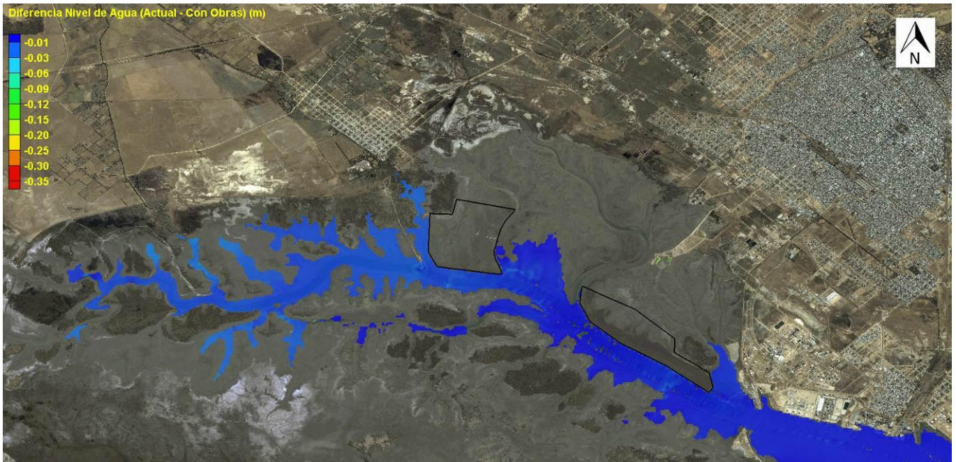
Figura 39. Incremento del Nivel Máximo de agua (Pleamar) debido al dragado y refulado
