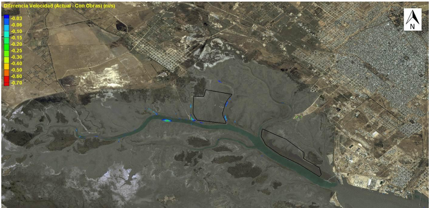
Figura 45. Incremento de Velocidad Máxima en creciente (flujo) debido al dragado y refulado
