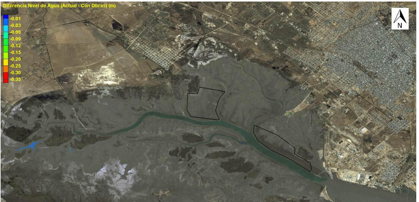
Figura 41. Incremento del Nivel Mínimo de agua (Bajamar) debido al dragado y refulado
