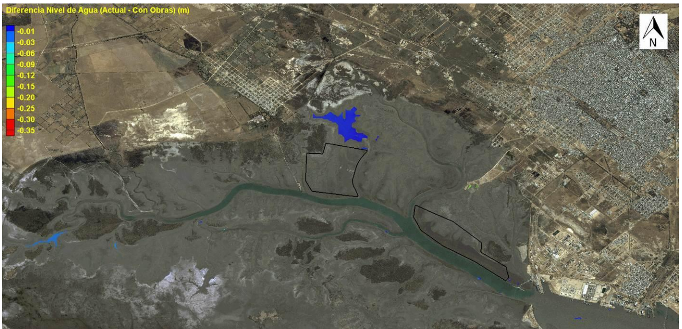
Figura 40. Incremento del Nivel Medio de agua para un instante medio del ciclo de mareas debido al dragado y refulado
